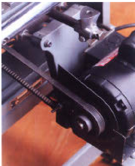
شکل ۱۲-۳۳- تسمه‌ی انتقال نیرو و حرکت.
