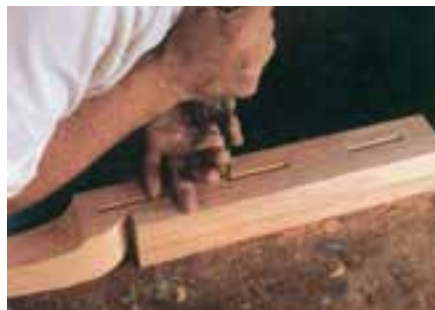
شکل ۹-۲۴ - تبدیل گوشه‌های قوسی به چهارگوش، به وسیله‌ی مغار یا اسکنه.
