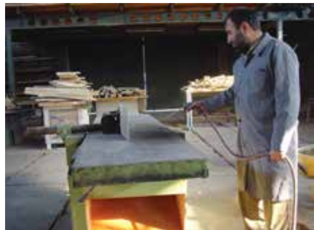
شکل ۱۲-۶- غبارگیری ماشین با شیلنگ باد.
