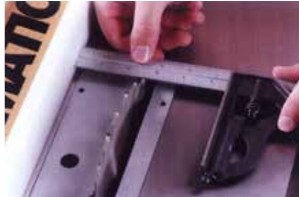
شکل ۱۲-۱۹- تنظیم فاصله‌ی تیغه تا گونیا.
