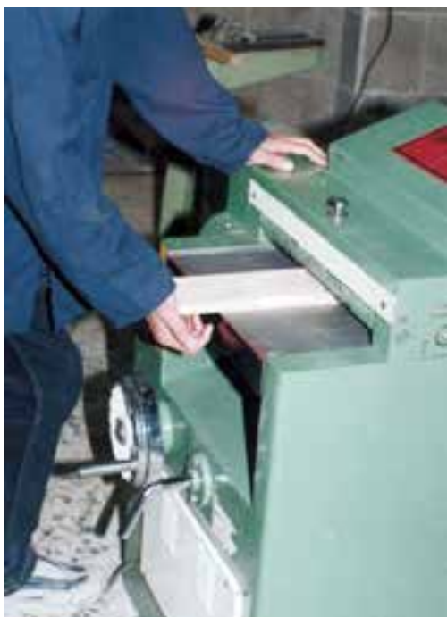
شکل ۴۲-۷- (روش ایمنی هدایت چوب به داخل ماشین).
