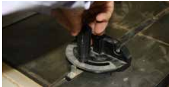
شکل ۱-۵۸-۱ برش عرضی چوب به وسیله‌ی گونیاى متحرک (عرضی).
