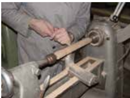
شکل ۱۱-۶۱- گرد کردن کامل قطعه چوب هشت ضلعی.
