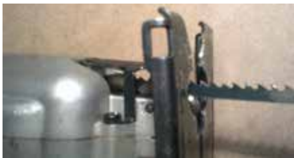
شکل ۱۴-۱۵. شیار ویژه‌ی گونیا.
