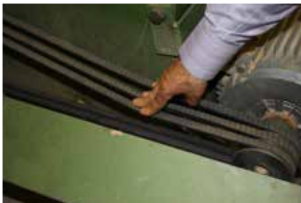
شکل ۲۲-۱- تنظیم سفتی تسمه
