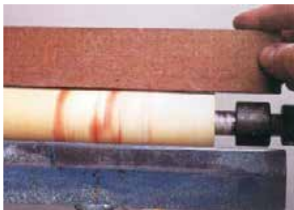
شکل ۱۱-۵۱- کنترل صافی قطعه چوب گرد شده.
