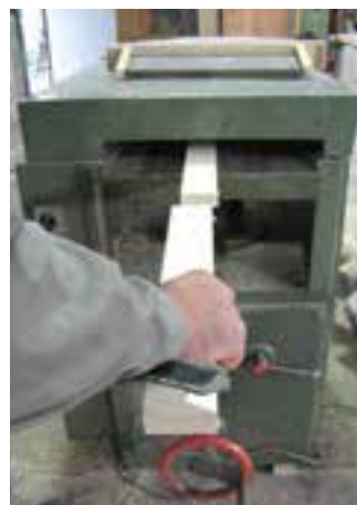
شکل ۷-۳۲ - روش صحیح وارد کردن چوب.
