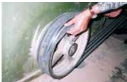
شکل ۹-۳- چگونگی تعویض تسمه.
