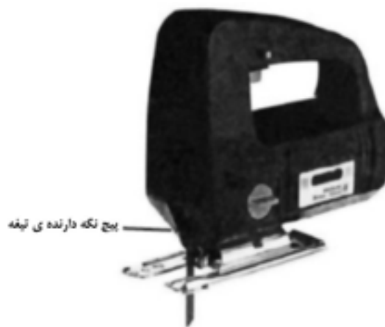
شکل ۱۶-۱۵- پیچ نگه‌دارنده‌ی تیغه.
