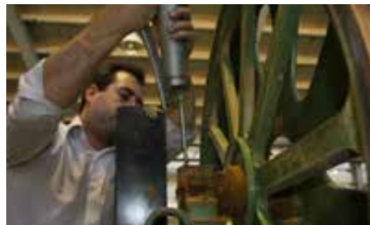
شکل ۳-۱. گریس‌کاری یاتاقان فلکه (اره).
