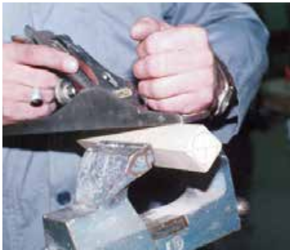
شکل ۱۱-۲۴- پیغ (زدن گوشه‌های تیز چوب).
