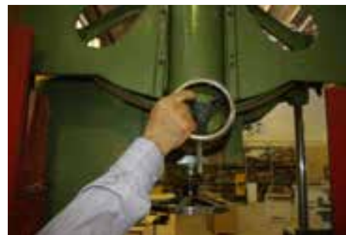
شکل ۷-۲- تنظیم لبه‌ی تیغه اره با لبه‌ی فلکه توسط فرمان مربوطه.
