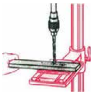
شکل ۱۹-۳۷- سوراخ کاری قطعات طولی.
