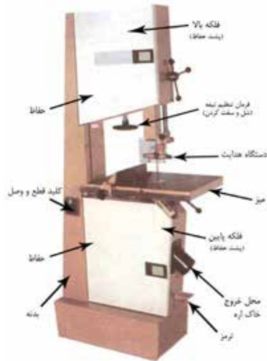
شکل ۴۱-۱. قسمت‌های مختلف یک ماشین اره‌نواری.
