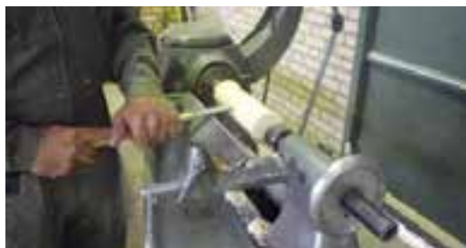
شکل ۱۱-۱۰- تکیه‌گاه کوچک مغار، برای قطعات کوتاه.
