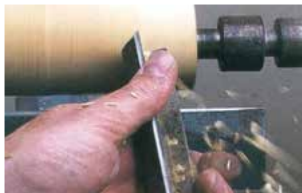
شکل ۱۱-۵۰- گرد کردن نهایی چوب با مغار گلوبی.
