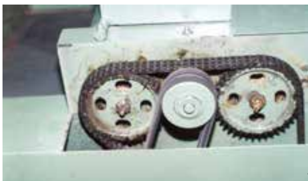
شکل ۱۸-۷- زنجیر انتقال نیرو و قدرت به غلتک‌ها.
