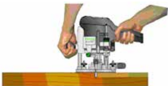
شکل ۱۶-۲۶- دوراهاه زدن قطعه کار با دستگاه اورفرز.
