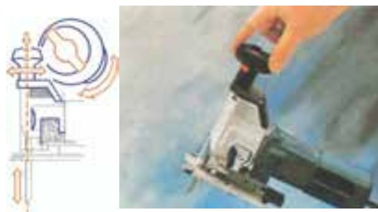
شکل ۱۵-۴۲- تعویض تیغه اره.
