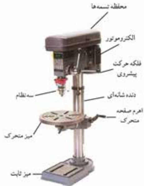
شکل ۱۹-۴- دریل ستونی پایه‌دار و قسمت‌های آن.
