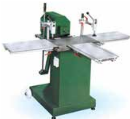
شکل ۹-۱ - ماشین کُم‌کن با صفحه‌ی ثابت و الکتروموتور متمرک.
