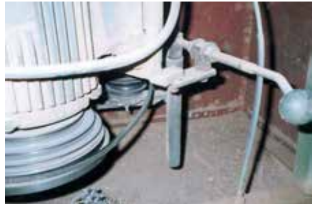
شکل ۱۱-۶- فراه کردن تسمه از پولی.
