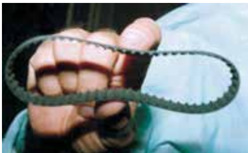
شکل ۱۴-۸- تسمه‌ی انتقال نیرو.
