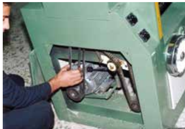
شکل ۸-۸- کنترل مقدار کشش تسمه‌ها.
