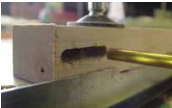
شکل ۹-۲۰- ایجاد سوراخ‌هایی با فاصله‌ی مدود ۲ میلی‌متر از همدیگر.
