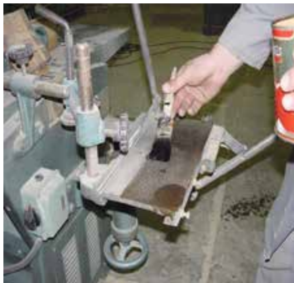
شکل ۱۲-۱۰- چرب کردن صفحات با (روغن).
