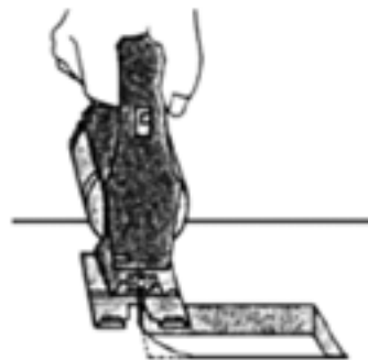
شکل ۱۵-۳۷- نمونه‌ی بریدن گوشه‌های داخلی با زاویه‌ی ۹۰ درجه.
