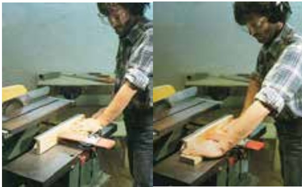
شکل ۱-۴۴-۱- گونیایی کردن پوب قبل از برش.
