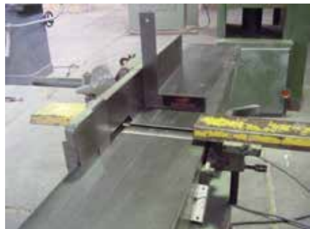
شکل ۳۰-۴. کنترل گونیا ماشین.
