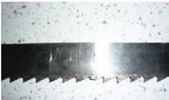
شکل ۱-۷۰- ترک تیغه اره از ممل جوش.
