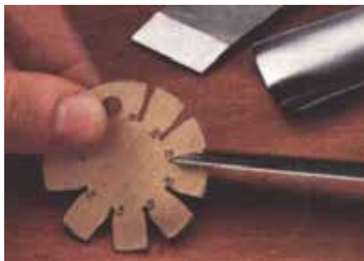
شکل ۴-۵- شابلن مخصوص کنترل زاویه‌ی رنده.
