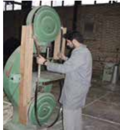
شکل ۶-۲- نمونه‌ی جا انداختن تیغه اره.
