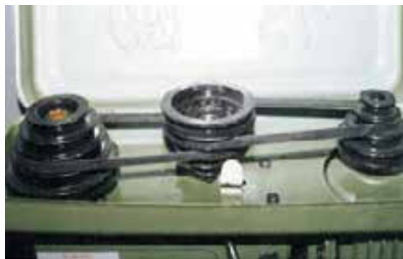
شکل ۱۹-۱۳- تغییر دور پله‌ای در دستگاه دریل ستونی.
