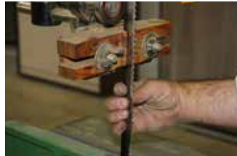
شکل ۲-۲. به کمک دست، کشش مناسب تیغه اره را کنترل کنید.
