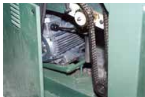
شکل ۷-۱۳. حفاظ تسمه، زنجیر، الکتروموتور و ...
