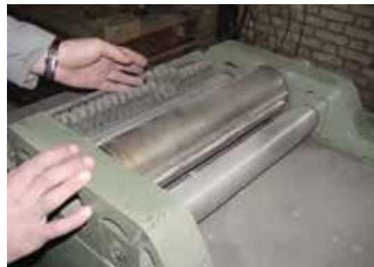
شکل ۷-۲۹- کنترل تمیزی شانه‌ها.
