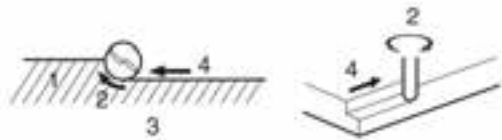
شکل ۱۶-۲۲- به جهت حرکت تیغه (روی قطعه کار، نسبت به گردش تیغه مول ممور فود توجه کنید.
