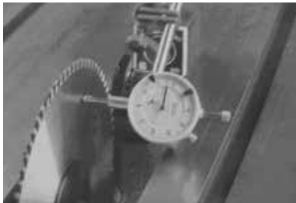
شکل ۱۲-۲۴- کنترل لنگی تیغه با دستگاه لنگی‌سنج.
