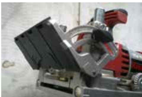
شکل ۴-۱۷- گونیا‌ی یک دستگاه فرز بیسکویتی.
