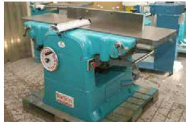
شکل ۴-۴- ماشین کفرند با بدنه چدنی.
