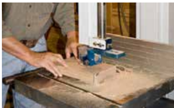
شکل ۱-۳۵-۱. فاصله‌ی ارتفاع سطح چوب با دستگاه هدایت.
