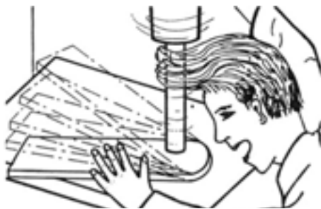
شکل ۱۹-۲۶- درگیر شدن مته با موی سر.
