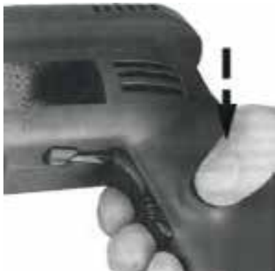
شکل ۱۹-۴۲ - فشردن ضامن کلید.
