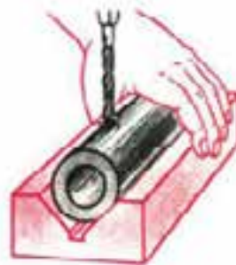
شکل ۱۹-۳۸ - سوراخ‌کاری جسم استوانه‌ای.
