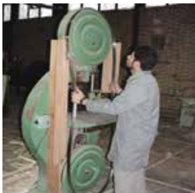
شکل ۵-۲. خارج کردن تیغه اره از روی فلکه‌ها.
