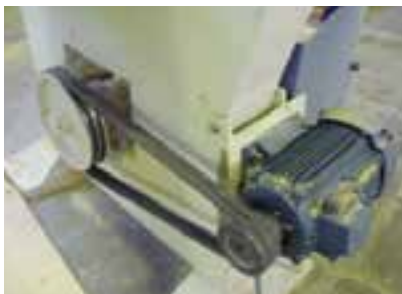
شکل ۳-۴. انتقال نیرو توسط تسمه.
