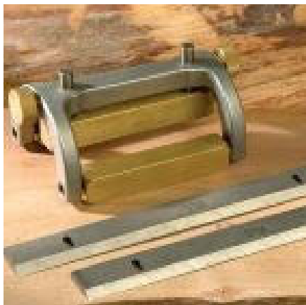
شکل ۸-۵- دستگاه تنظیم ارتفاع تیغه.
