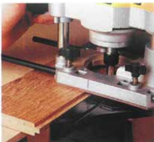
شکل ۱۶-۴- دوراهه زدن، با دستگاه اورفرز.
