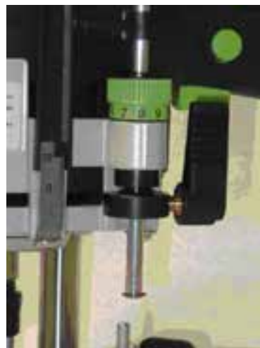
شکل ۱۳-۱۶- درمهی تعیین ارتفاع تیغه.
