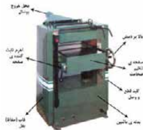
شکل ۵-۷- مشخصات ظاهری ماشین گندگی.
