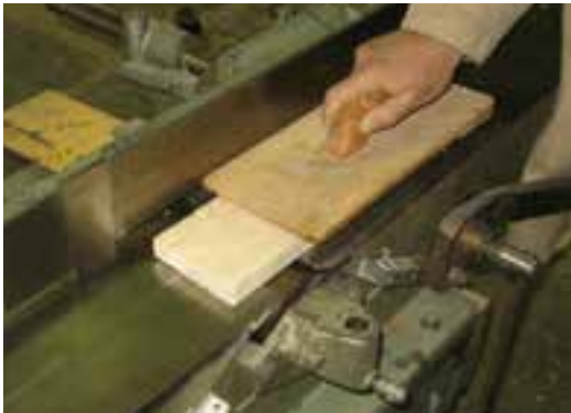
شکل ۱۷-۴-ب - رنده کردن چوب‌های کم ضخامت.
