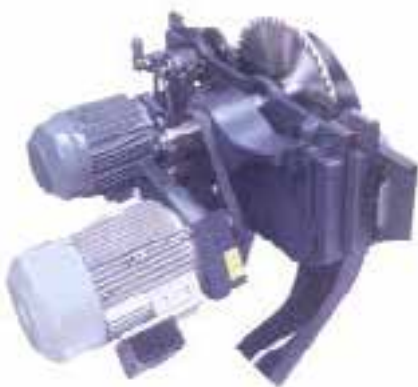
شکل ۱۲-۷- الکترو موتور و سیستم انتقال نیرو.
