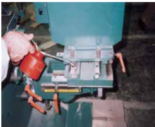
شکل ۱۳-۱۰- (روغن‌کاری) ممل ریل‌ها.
