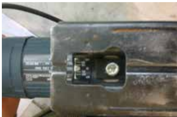
شکل ۱۳-۱۵. قسمت مدرج صفحه‌ی دستگاه اره عمودبر.
