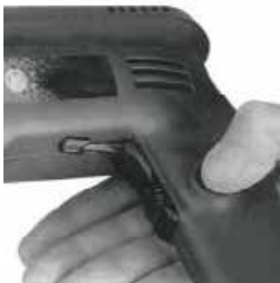
شکل ۱۹-۴۳ - رها کردن کلید و کار دائم دریل.
