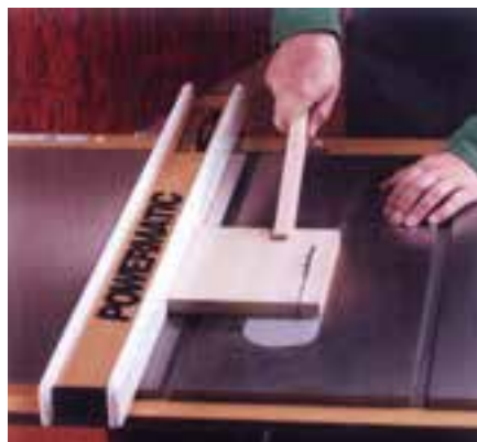
شکل ۱۲-۳۷- استفاده از چوب کمکی سافته شده در کارگاه.
