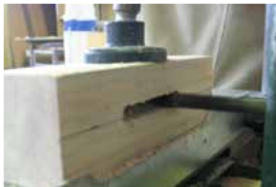
شکل ۱۰-۲-۱- گیره‌ی نگه‌دارنده‌ی قطعه کار.
