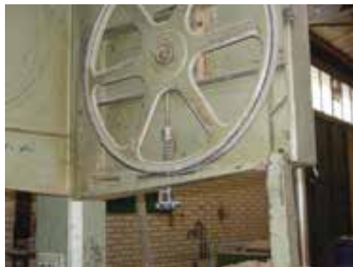
شکل ۱۹-۳- میله ی مارپیچ فلکه، همواره باید تمیز و گریس کاری شده باشد.
