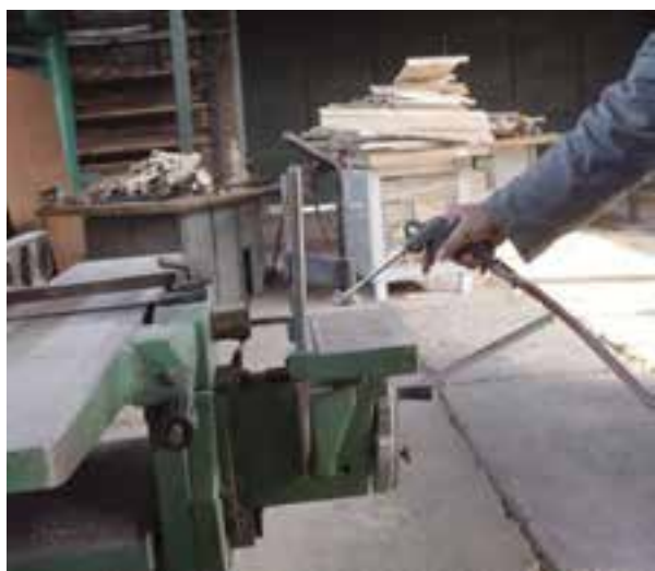
شکل ۱۰-۱۱- غبارگیری قطعات ماشین.
