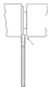
شکل ۱۱-۱۶- مغار نیزه‌ای یا قطع‌کن؛ برش عرضی.
