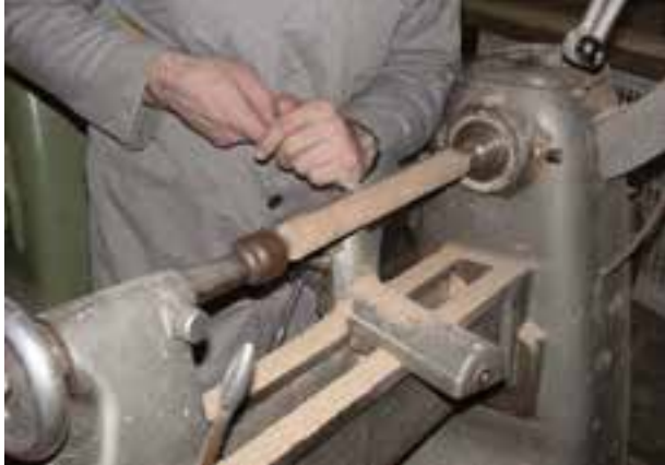
شکل ۱۱-۲۷- نمونه‌ی قرار گرفتن مغار گلوبی هنگام فراطی.
