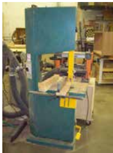
شکل ۹-۱- یک ماشین اره‌نواری، با حفاظ کامل.
