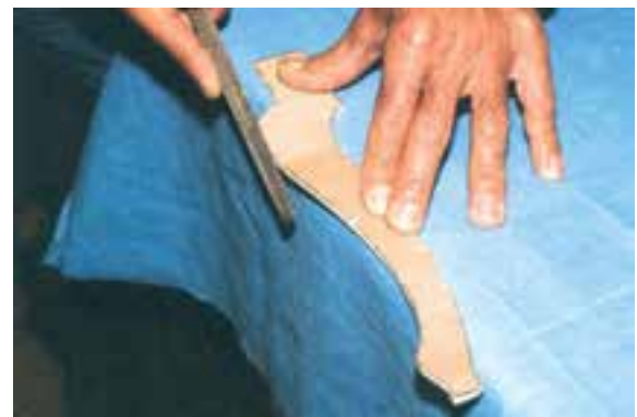
شکل ۱۸-۲۲- نمونه‌ی پرداخت کردن مسیر برش.
