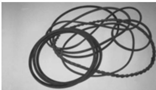
شکل ۱۰-۴-۱. انواع تسمه‌های انتقال نیرو.
