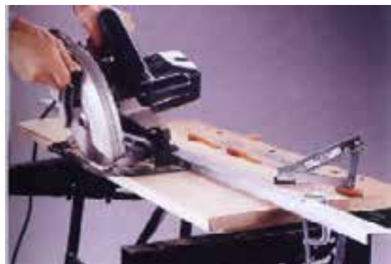
شکل ۱۳-۱۴ برش با استفاده از تکیه‌گاه.
