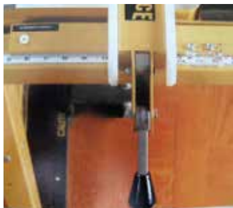
شکل ۱۲-۲۳- تنظیم اندازه‌ی برش.
