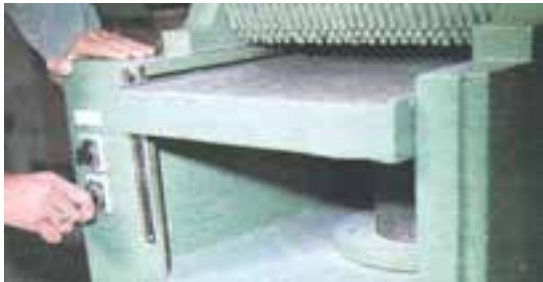
شکل ۷-۳۰- نمونه‌ی ایستادن در هنگام روشن کردن ماشین.
