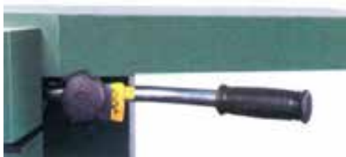
شکل ۸-۴- اهرم تنظیم بار صفحه‌ی کفرند.
