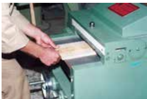
شکل ۳۷-۷- نمونه‌ی رندیدن چوب نازک.
