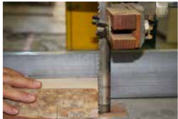
شکل ۳-۳-۱- شرایط ایمنی دست، هنگام کار با اره.
