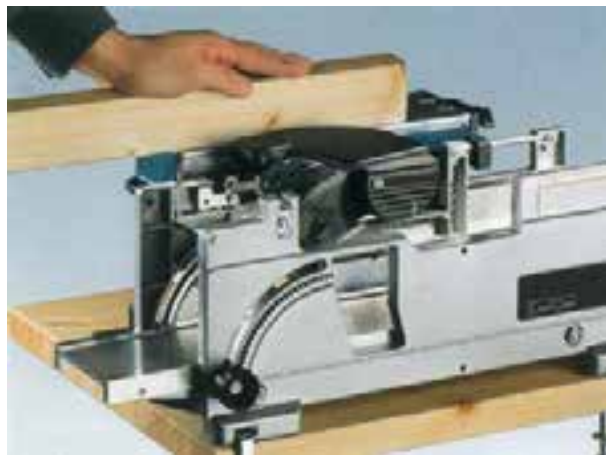
شکل ۱۴-۲۰- کاربرد میز کمکی در موقع رندیدن.
