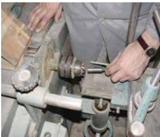
شکل ۷-۱۰-۱- خارج کردن مته از سه‌نظام.
