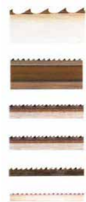
شکل ۱-۴۸-۱- فرم‌های مختلف دندانه‌ی اره‌نواری.
