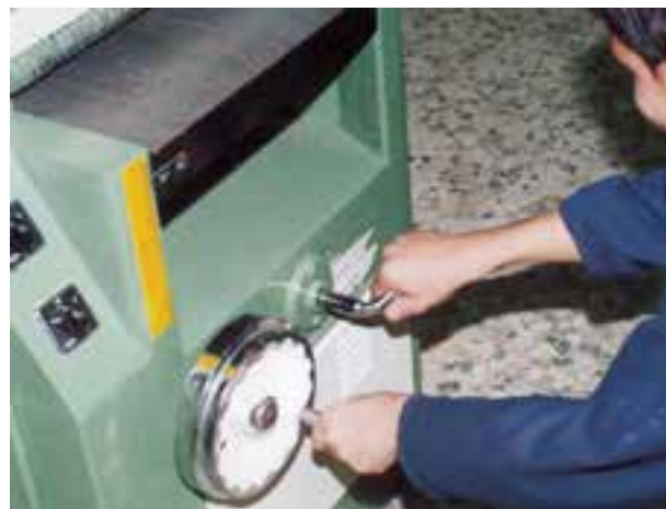
شکل ۱۹-۷- تنظیم صفحه و ممک نمودن اهرم مربوطه.
