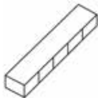
شکل ۹-۳۰- تقسیم نر چوب به ۵ قسمت مساوی.
