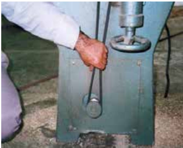
شکل ۱۰-۱۰- کنترل تسمه‌ی ماشین.
