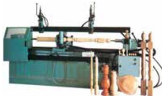
شکل ۱۱-۲ - ماشین خراطی نیمه اتوماتیک.
