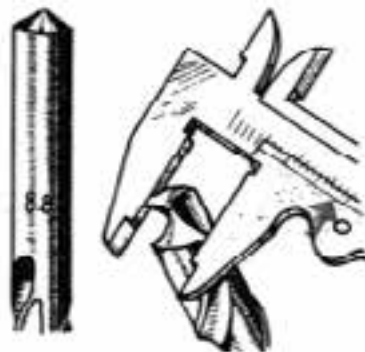
شکل ۱۹-۴۸- اندازه‌گیری قطعه به وسیله‌ی کولیس.
