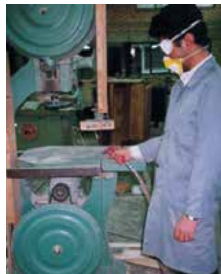
شکل ۱۱-۳- نظافت ماشین پس از کار.
