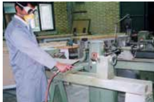
شکل ۱۱-۴۴- گردگیری و نظافت ماشین فراطی.
