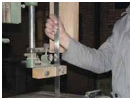
شکل ۵۱-۱- کنترل سفتی تیغه به کمک دست.
