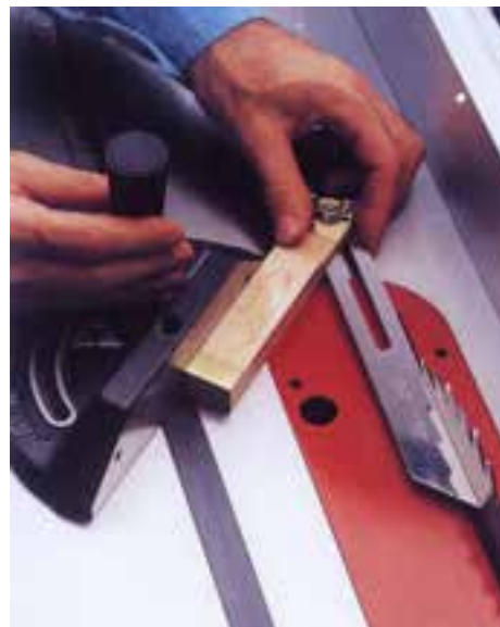
شکل ۱۲-۲۰- تنظیم زاویه‌ی تیغه
