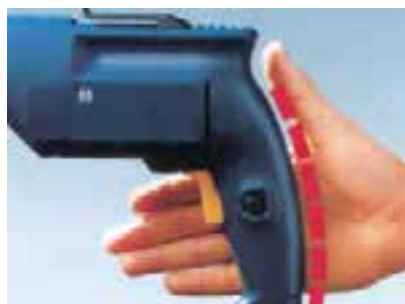
شکل ۱۹-۴۰ - دسترسی دکمه‌ی روشن و خاموش دریل.
