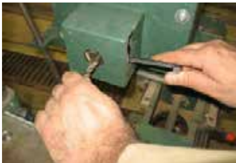
شکل ۹۱۷- مهم‌ کردن مته داخل سه‌نظام.
