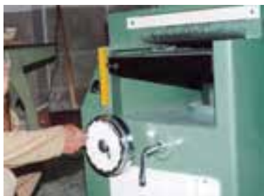
شکل ۲۱-۷- آزمایش روان بودن حرکت صفحه‌ی متمرک.
