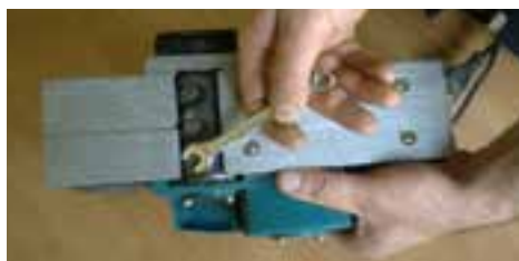
شکل ۱۴-۲۳- خارج کردن تیغه‌ها از جایگاه.
