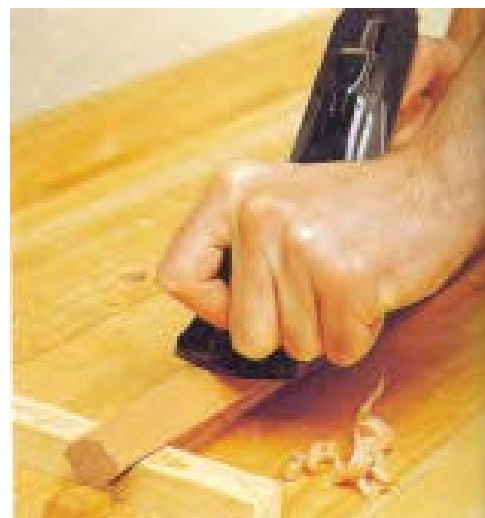
شکل ۲۷- نمونه‌ی پرداخت قید شش‌ضلعی با رنده پرداخت.
