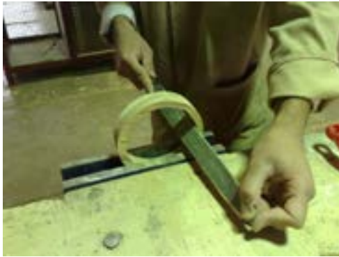
شکل ۱۲-۱۹۳- پرداخت ملقه‌ی چوبی.
