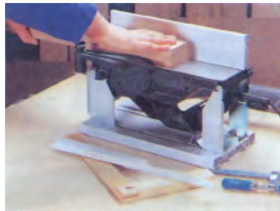
شکل ۱۱-۲۱- یک رو و یک نر کردن چوب کلاف در.
