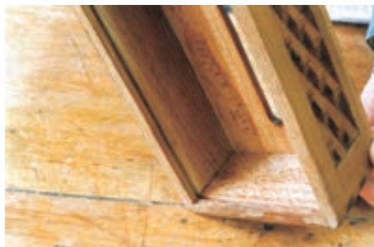
شکل ۹-۶۷- کنشکاف داخل بدنه‌های یک جعبه دستمال کاغذی.
