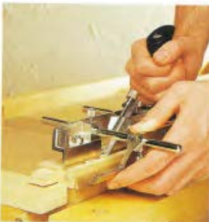
شکل ۹-۱۰۰- شیار انداختن داخل قیدهای عرضی.
