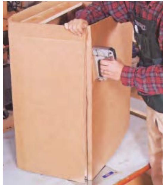
شکل ۸-۲۲- کاربرد منگنه‌ی دستی در بسته‌بندی کالاها.
