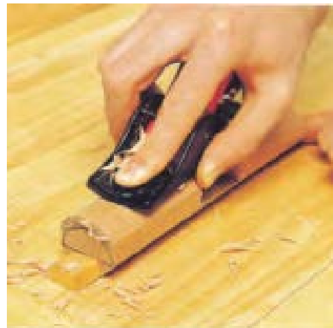
شکل ۲۶- نمونه‌ی پرداخت قطعه‌ای با مقطع نیم‌گرد.
