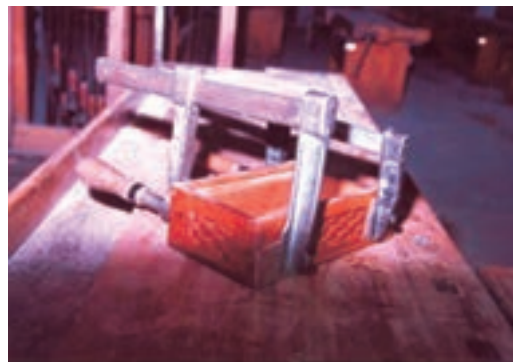
شکل ۹-۶۹- مونتاژ بدنه‌های جعبه.
