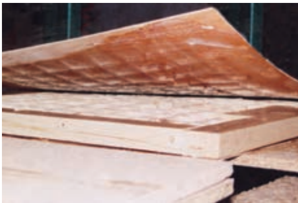
شکل ۱۱-۳۷- قرار دادن صفحه‌ی دوم، روی کلاف.
