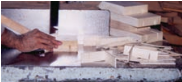
شکل ۱۱-۳۱- تولید شبکه‌های داخل در.
