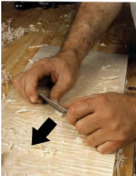
شکل ۲۸- نمونه‌ی گرفتن لیسه با شست دست و هدایت آن.
