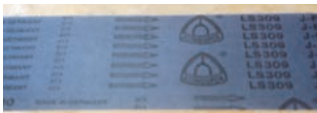
شکل ۷-۳۲- هنگام سوار کردن نوار سنباده روی دستگاه، به جهت فلش‌ها و حرکت غلتک‌ها توجه کنید.
