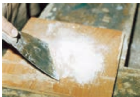
شکل ۱۲-۴ پودر مل و سریش را مخلوط کرده، در وسط تخته بتونه جمع کنید.
