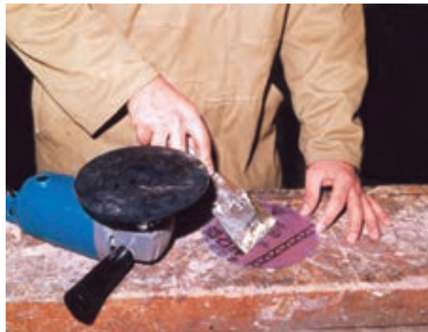
شکل ۷-۳۶- چسب به طور یکنواخت و به صورت یک لایه نازک روی سنبناده گرد دستگاه پهن شود.
