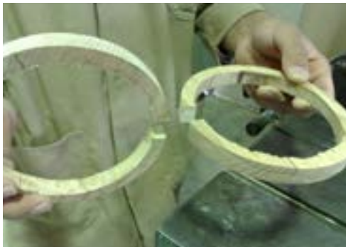
شکل ۱۲-۱۹۵- ملقه‌های چوبی برش فورده در مقابل هم.
