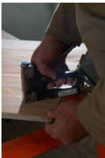
شکل ۱۸-۶- روکش را به کمک منگنه روی صفحه ثابت کنید.
