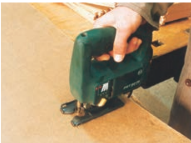
شکل ۹-۶۱- برش کف جعبه با اره عمودبُر برقی - دستی.
