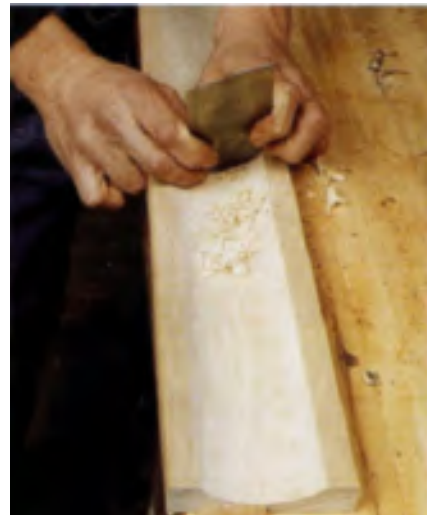
شکل ۲-۵- کاربرد لیسه با لبه‌ی نیم گرد.
