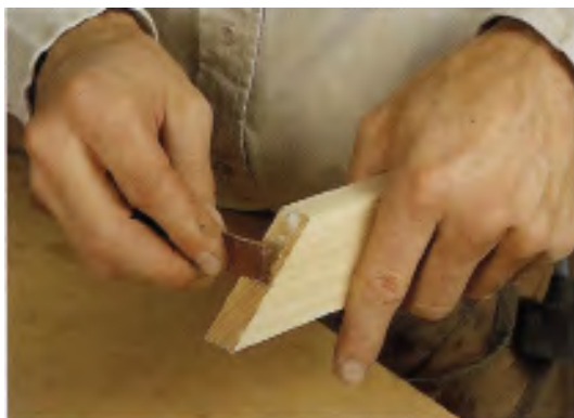
شکل ۱-۴۶- برای چسباندن دو سر چوب به یکدیگر، باید چسب زنی را یکبار انجام داد، و پس از مموشدن چسب هنگام بستن قطعات، مجدداً به سر چوب چسب زد.
