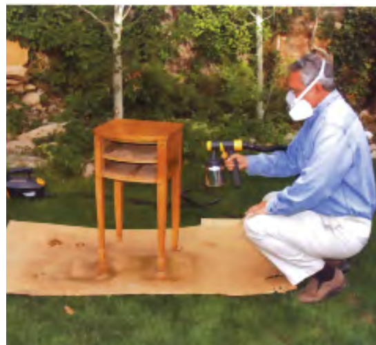
شکل ۲۳-۴. رنگ‌کاری با پیستوله (رنگ پوششی).
