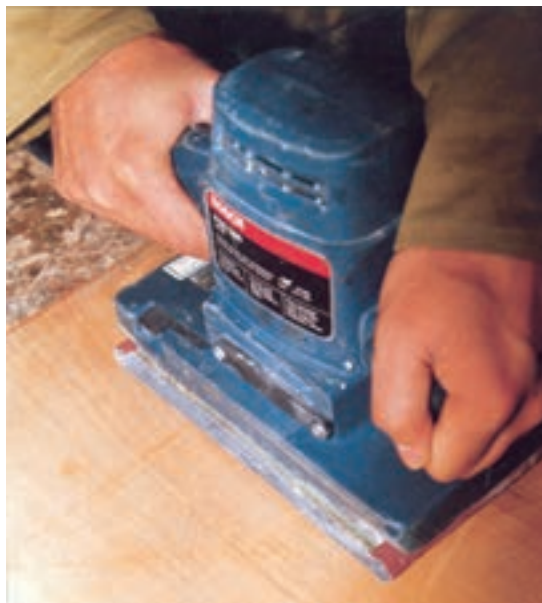
شکل ۷-۱۱- سنباده کاری در جهت الیاف.
