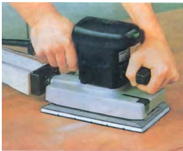
شکل ۳-۱۴- سنباده‌زنی با یک دستگاه سنباده لرزان کامل.
