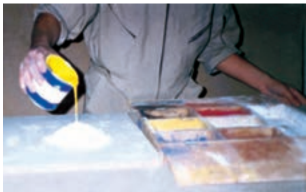
شکل ۴-۳- مواد تشکیل‌دهنده‌ی بتونه روغنی.
