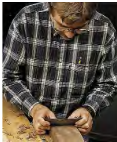
شکل ۲-۳۰. پرداخت سطوح قوس دار به وسیله لیسسه.
