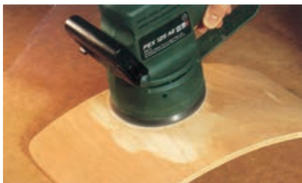
شکل ۲۷-۷- هنگام تعویض ورق سنباده باید دو شاخه دستگاه را از پریز خارج کنید.
