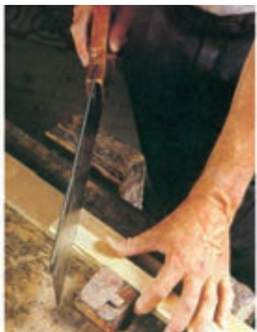
شکل ۱۰-۱۱- برش زهوار، با زاویه‌ی ۴۵ درجه.
