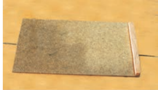
شکل ۹-۶۲. پسباندن زهوار به لبه‌ی کف جعبه.
