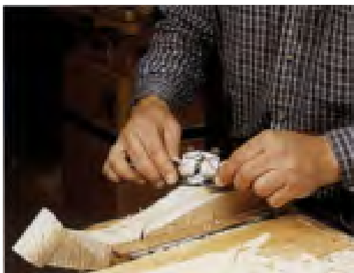
شکل ۲-۳۴. کاربرد رنده بال کبوتری، برای رندیدن قوس‌های داخلی و خارجی یک پایه سُم آهوئی.
