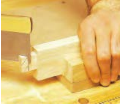
شکل ۹-۹۹- به اندازه رساندن زبانه با اره‌ی ظریف‌بُر (پشت‌دار).
