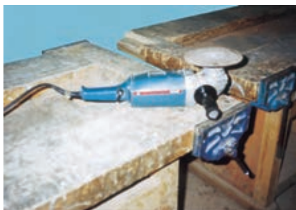
شکل ۷-۴۲- چگونگی قرار ایمنی دستگاه سنبناده بشقابی (روی میز کار).
