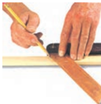
شکل ۱۰-۱۰- فلماکشی زهوار، با زاویه‌ی ۴۵ درجه.
