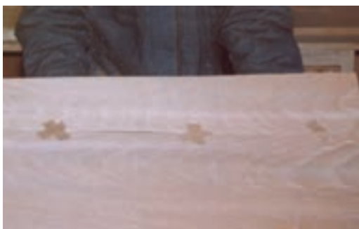
شکل ۵-۳۰- حمل صحیح (روکش‌ها).
