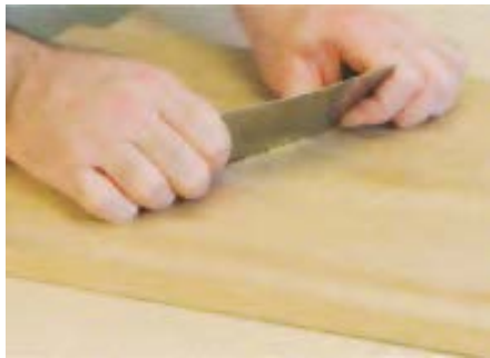
شکل ۲-۱۳- جهت حرکت لیسه، هنگام پُرزگیری.
