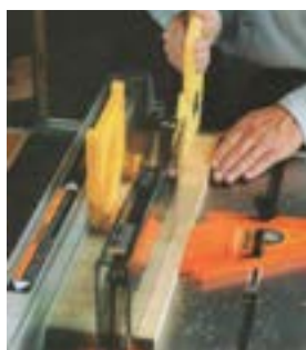
شکل ۱۲-۳- استفاده از وسایل کمکی در هنگام کار.
