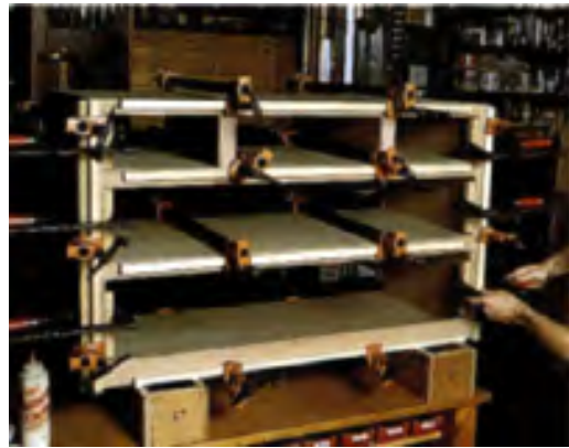
شکل ۱-۵۰- هنگام مونتاژ کابینت‌ها می‌توان برای محکم کردن و گرفتن دوئیدگی، از تنگ و پیچ‌دستی در جهات افقی و عمودی استفاده نمود.
