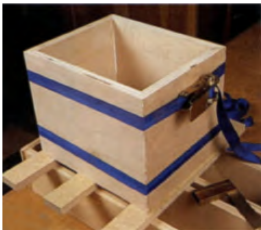
شکل ۱-۴۸- از گیره‌ی تسمه‌ای می‌توان برای چسباندن بدنه‌های صندوق مکتبی نیز استفاده کرد. با توجه به ارتفاع آن، می‌توان ۲ تسمه یا بیشتر به‌کار برد.
