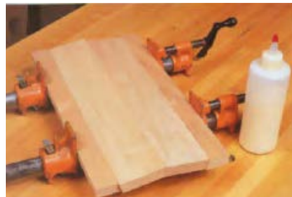
شکل ۱-۴۵- هنگام چسباندن تفته‌های درز شده به وسیله‌ی تنگ، نباید فشار تنگ، بیش از حد باشد، زیرا تفته‌ها قوس بر می‌دارد.
