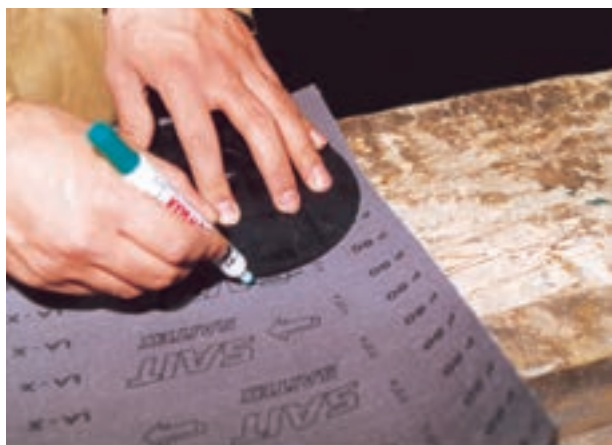
شکل ۷-۳۵- ترسیم گردی دیسک روی سنبله.
