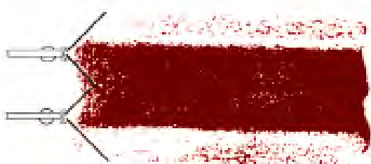
شکل ۴-۴۸- پوشش ۵۰ درصد رنگ، در هر رفت و برگشت.
