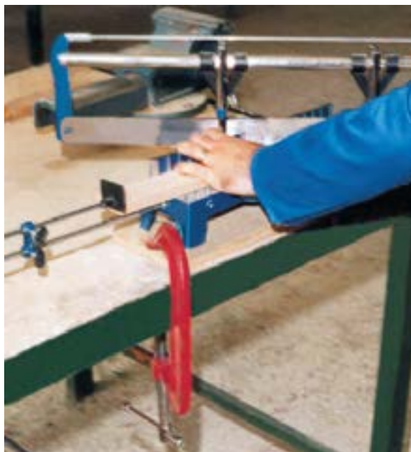
شکل ۸-۱۴- ایجاد برش ۴۵ درجه در گوشه‌های قیدهای قاب، به وسیله اره فارسی بر دستی.
