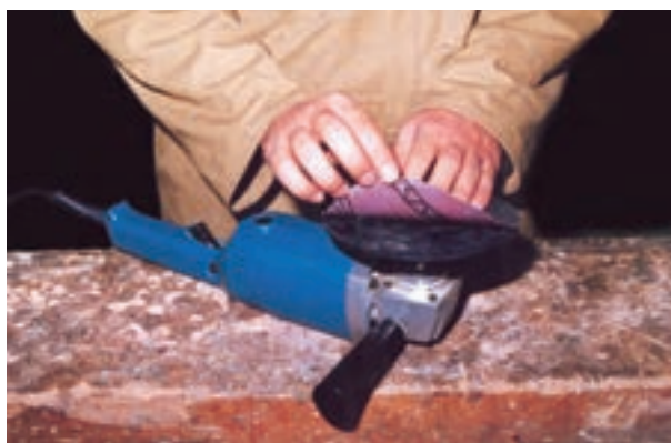
شکل ۷-۳۷- ورق سنبناده به دقت روی دیسک قرار گیرد.
