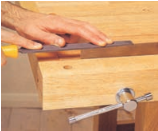
شکل ۲-۷- نمونه‌ی سوهان زدن ضخامت لیسه.
