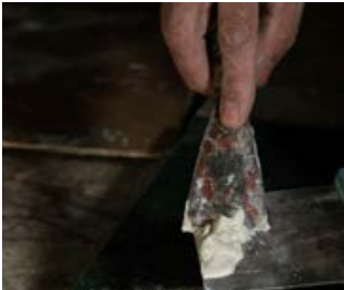
شکل ۴-۱۸- با کشیدن لیسه و کاردک به هم، باید آنها را تمیز کرد.
