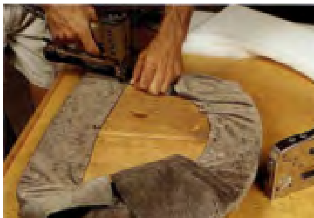
شکل ۸-۵- کاربرد منگنه در رویه‌کوبی.
