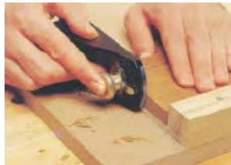
شکل ۲۲-۲- نحوه‌ی رندیدن نر تخته خرده چوب، با استفاده از چوب کمکی.
