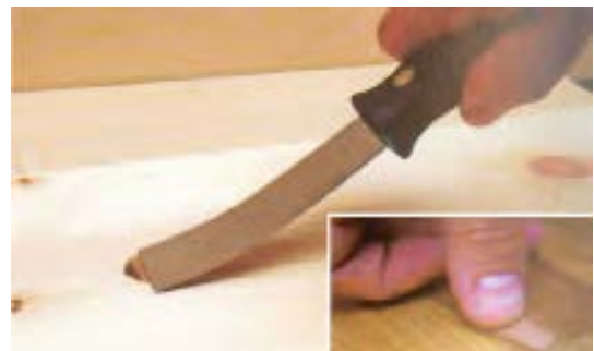
شکل ۴-۱۷- فقط باید ترک‌ها، زدگی‌ها و... را بتونه کشید.
