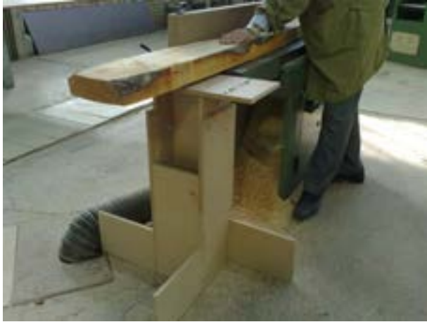
شکل ۹-۱۴- کاربرد میز کمکی برای ماشین کفرند.
