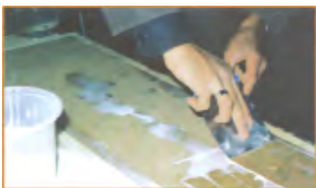
شکل ۵-۳۲- نمونه‌ی پخش کردن چسب به وسیله‌ی کاردک.
