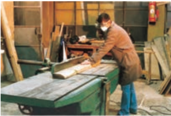
شکل ۹-۹- مقدار باز بودن زیاد گونیا، فطرآفرین است.
