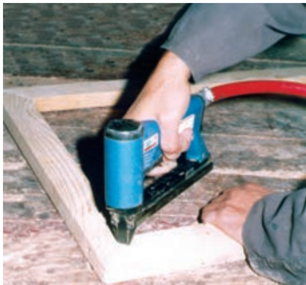
شکل ۸-۱۶- منگنه زدن روی درزهای ۴۵ درجه شده.
