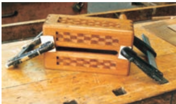
شکل ۹-۷۰- بستن سقف به بدنه‌ها.
