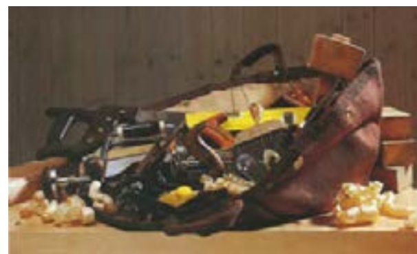
شکل ۲-۱۶- ریختن ابزارها روی هم، علاوه بر کاهش تیزی، از دقت آنها نیز می کاهد.
