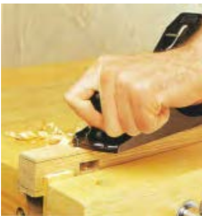
شکل ۹-۱۰۱- سافت پایه به شکل دم گاو، با رنده.
