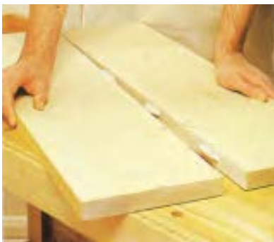
شکل ۹۴- صفحه‌ی رویه، با اتصال بیسکویتی.
