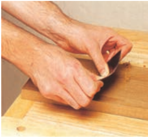
شکل ۲-۱۲- از فم کردن زیاد لیسه هنگام لیسه‌کاری فودداری شود.
