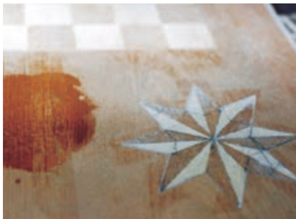
شکل ۱۳-۴. رنگ بتونه، باید با قسمت نمودار قطعه کار هم رنگ باشد.
