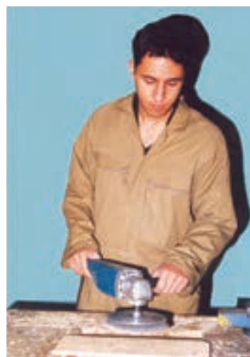
شکل ۷-۴۰- هدایت و کنترل صمبغ دستگاه سنباده.
