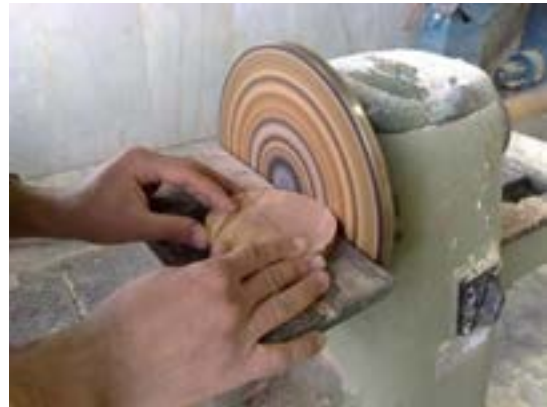
شکل ۱۲-۱۹۱- پرداخت قطعه چوب دایره شکل.
