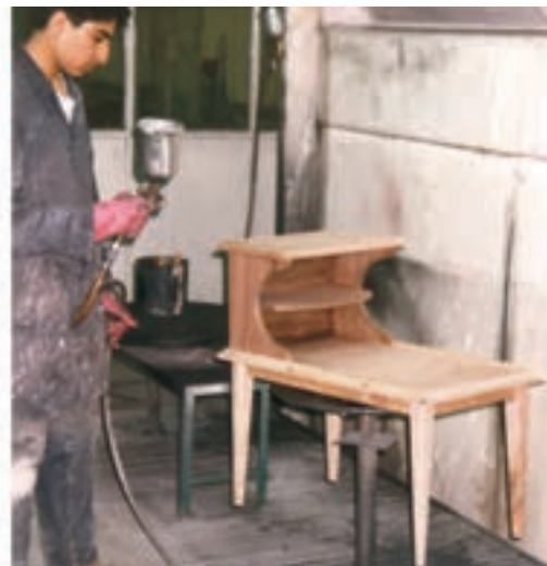
شکل ۲۴-۴. رنگ‌کاری با پیستوله (رنگ شفاف).
