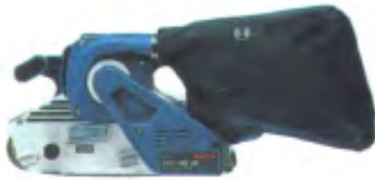
شکل ۷-۷- دستگاه سنباده‌ی نواری با کیسه کرده سنباده.
