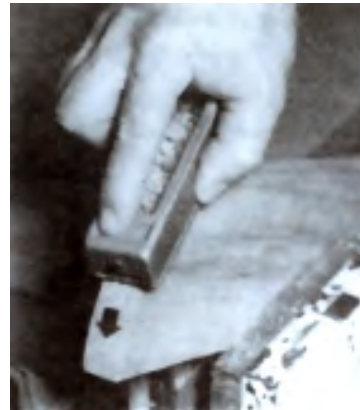
شکل ۲۵- استفاده از چوبسای رنده‌ای، برای صاف کردن قطعه‌ی قوس‌دار.
