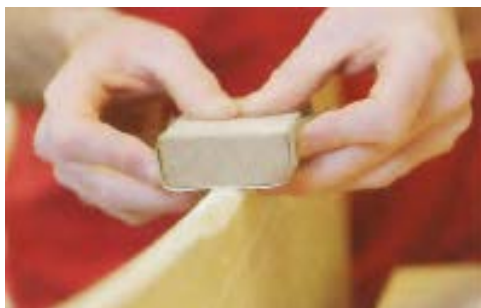
شکل ۳-۲۱. طریقه‌ی سنباده‌کاری نر قطعات با دو دست.
