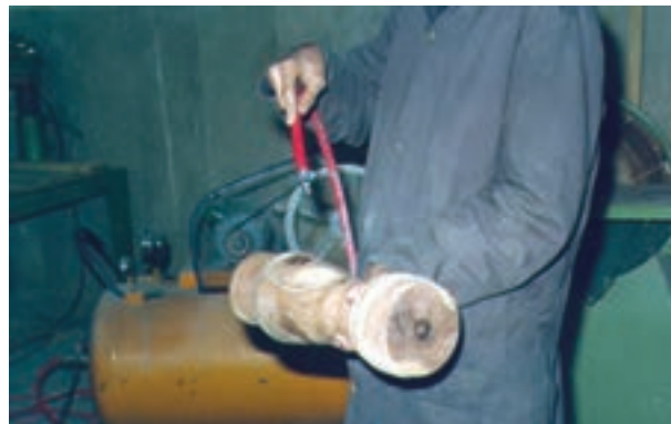
شکل ۲۸-۳. بادگیری قطعات سنباده فورده.
