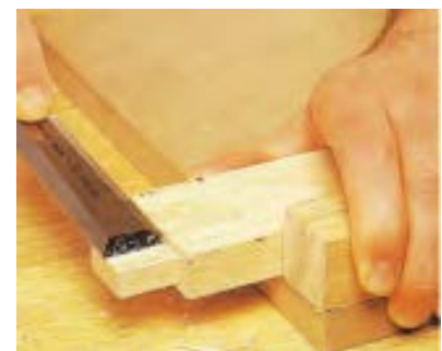
شکل ۹-۹۸- اندازه کردن زبانه با مغار.
