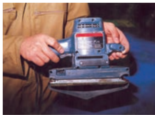
شکل ۷-۴۶- شل و سفت بستن سنباده به دستگاه.
