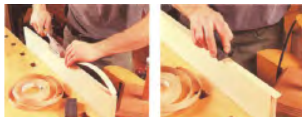
شکل ۱-۴۴- برای چسباندن لب‌چسبان‌هایی از جنس روکش طبیعی یا مصنوعی، می‌توان از اتو استفاده کرد.
