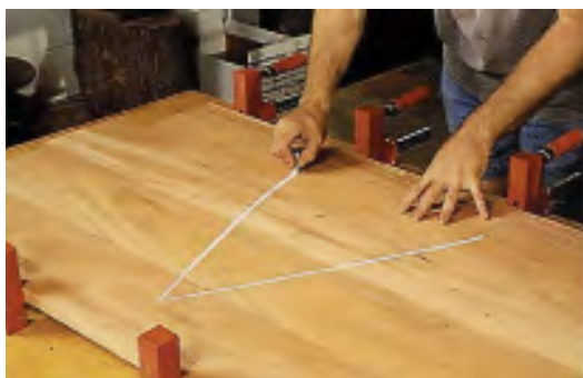
شکل ۱-۴۷- تفته‌های درز شده را باید کنار هم (روی تنگ‌ها) قرار داد و علامت مثلث ( \Delta ) را روی آن ترسیم کرد؛ سپس باید آنها را چسب زد، در جای خود قرار داد و تنگ‌ها را ممکن نمود.
