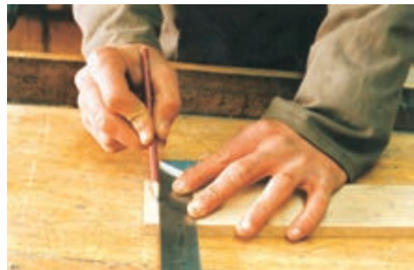
شکل ۹-۶۳. فم کشی ممل اتصال با گونیا.
