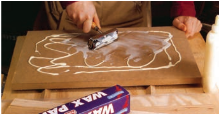
شکل ۷- عملیات چسب‌زنی نئوپان برای روکش کاری
