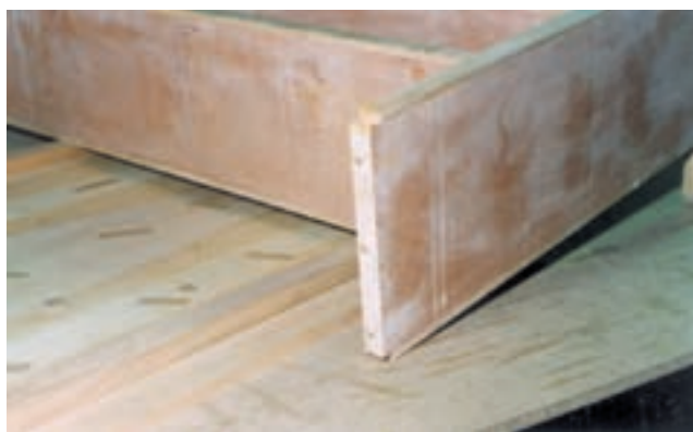
شکل ۱۶- جاسازی دوبل در نو بدنه برای اتصال به کلاف زیر صفحه میز
