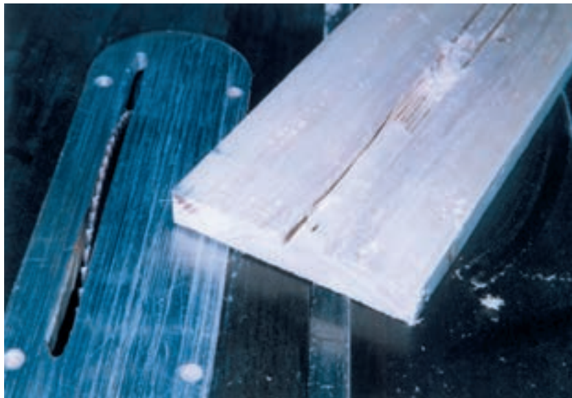
شکل ۱۹- ایجاد کنشکاف ریل جعبه با ماشین اره گرد در چند مرحله
