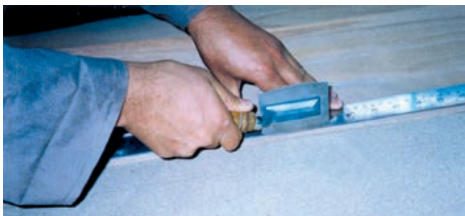
شکل ۱۷- قطع روکش به وسیله‌ی اره‌ی روکش‌بری
