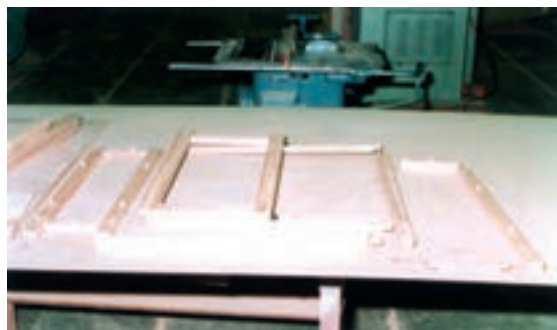
شکل ۱۲- کم کنی کلاف بدنه و طبقه‌ها
