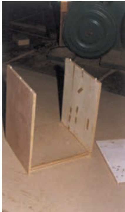
شکل ۲۰- مونتاژ کف و بدنه
