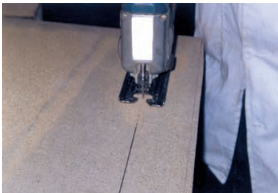
شکل ۲- بریدن نئوپان با اره‌ی عمودبر
