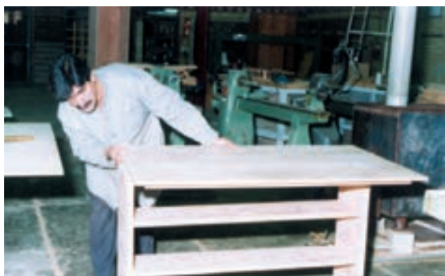
شکل ۱۷- نصب صفحه‌ی میز بر روی بدنه‌ها
