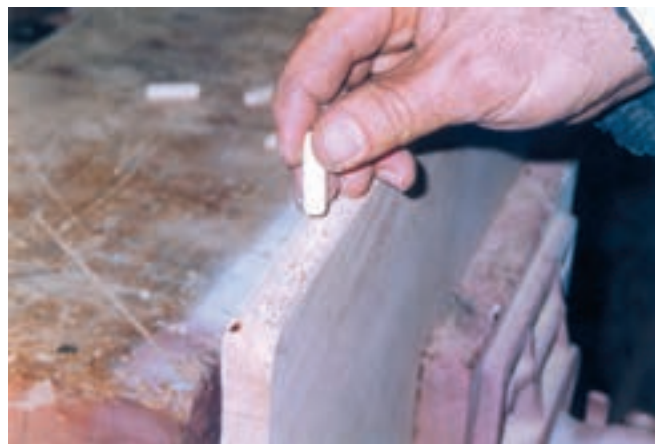
شکل ۲۵ - جازدن دوبل‌ها در نر صفحات
