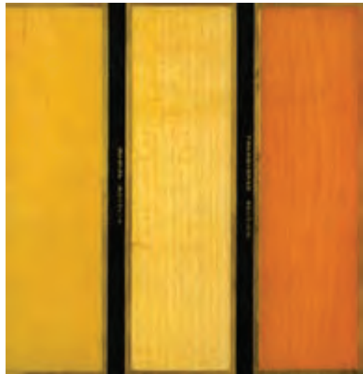
شکل ۱۰-۲۹ برش‌های عرضی، شعاعی و مماسی چوب توسکا.
