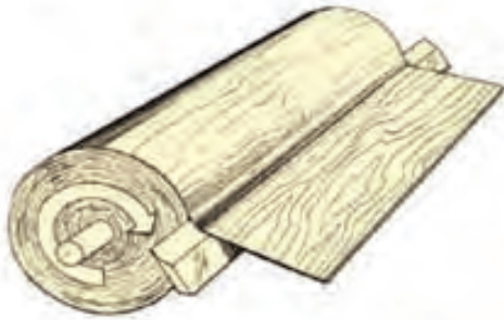
شکل ۱۰-۴۶ تهیهی روکش به روش لوله‌بری.
