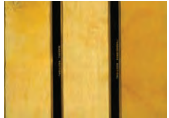
شکل ۱۰-۳۲ برش‌های عرضی، شعاعی و مماسی چوب ممرز.
