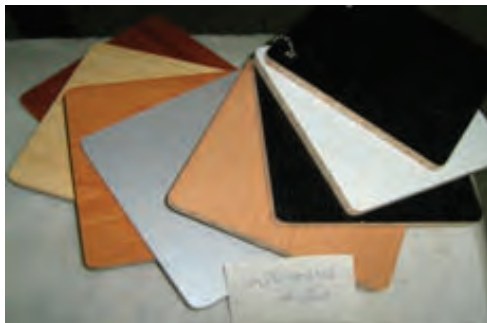
شکل ۱۰-۵۵ تخته فرده چوب (روکش شده با (روکش‌های ملامینه.
