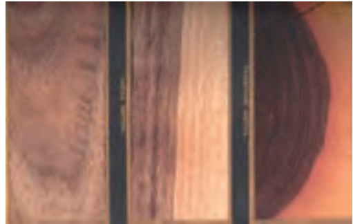
شکل ۱۰-۲۸ چوب گردو در سه برش عرضی، شعاعی، مماسی.
