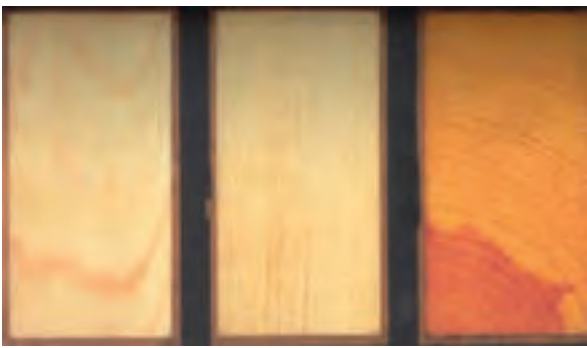
شکل ۱۰-۲۲ چوب کاج در سه برش عرضی، شعاعی، مماسی.
