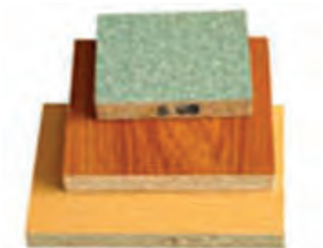
شکل ۱۰-۵۶ تخته فرده چوب با (روکش‌های مصنوعی).
