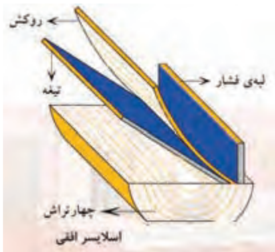
شکل ۱۰-۴۷ تهیهی روکش به روش اسلایسر افقی.
