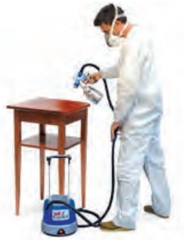
شکل ۱-۱۴. هنگام استفاده از پیستوله از ماسک ایمنی استفاده کنید.
