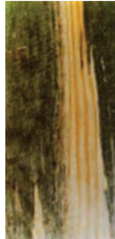
شکل ۸-۵- چوب آلوده به پوسیدگی آبی
