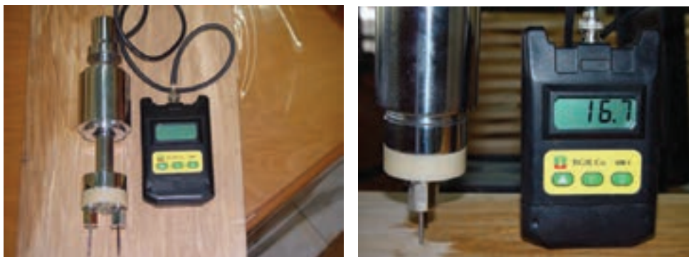
شکل ۹-۱- دستگاه رطوبت سنج الکتریکی
