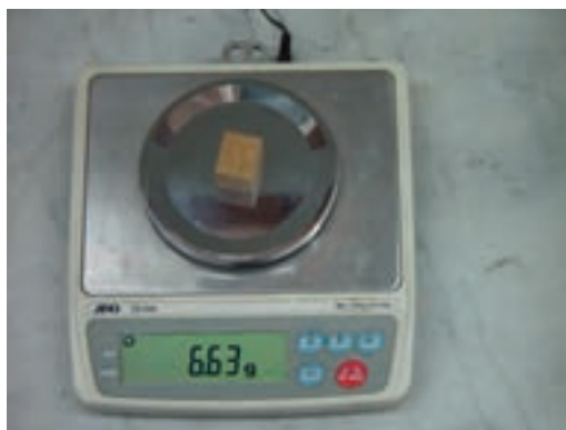
شکل ۱-۵- ترازوی دقیق و نحوه توزین نمونه چوب
