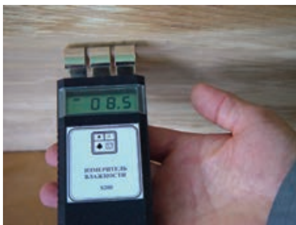
شکل ۱-۱- نوعی رطوبت سنج الکتریکی بدون الکتروود
