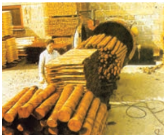
شکل ۴-۶- چوب‌های مختلف آماده برای اشباع
