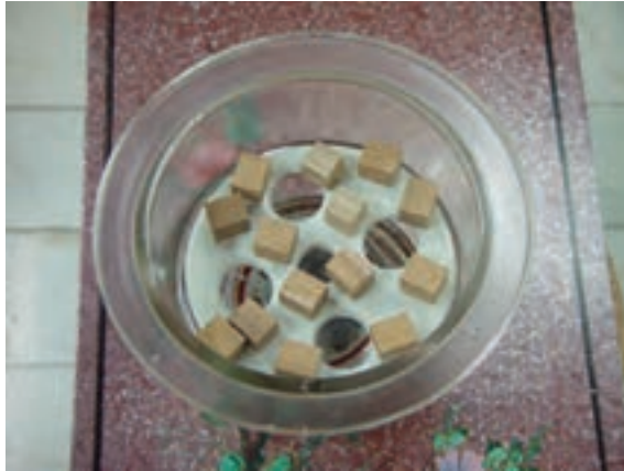
شکل ۱-۲- نمونه‌های آزمون رطوبت در داخل دسیکاتور
