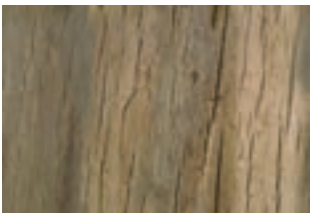
شکل ۱۴-۱- ترک‌های سطحی در تخته
