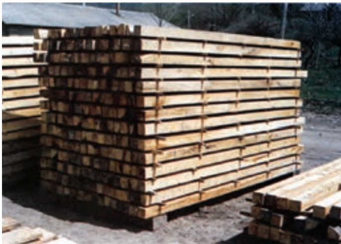
شکل ۱۲–۲. نحوه چوبدستک‌گذاری در یک دسته چوب
